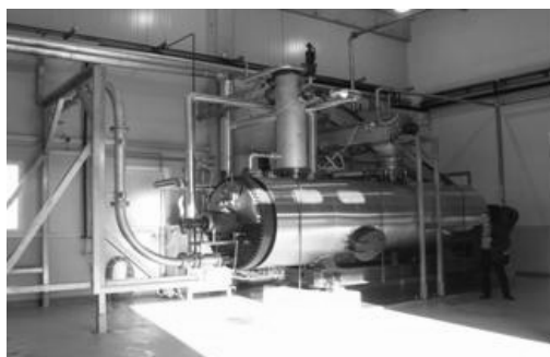
Rys. 11.8. Urządzenie do obróbki termiczno-ciśnieniowej austriackiej firmy Dauscher pracujące w zakresie temperatur do 1700C oraz ciśnieniu do 10 barów. (fot. materiały firmy Dauscher)
