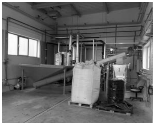
Rys. 11.5. Węzeł przyjęcia i obróbki substratów uciążliwych – odpadów poubojowych w biogazowni w Skrzatuszu k/Piły zbudowanej przez firmę ZENERIS. Obróbka odbywa się w zamkniętych pomieszczeniach, zastosowano filtry antyodorowe hal i zbiorników substratowych (fot. A. Myczko)
