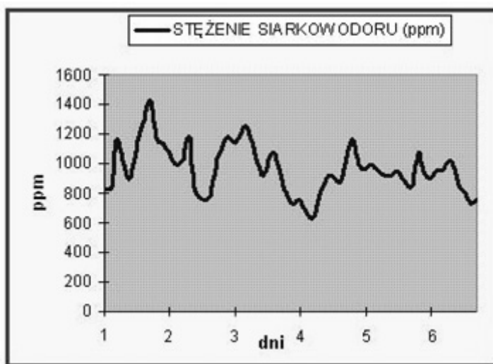
Rys. 10.5. Przykład zmian stężenia siarkowodoru w komorze fermentacyjnej; źródło: Aeroenergetyka 2010, http://agroenergetyka.pl/
